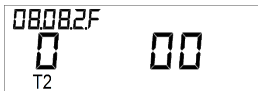
Рисунок 2.18 – Меню 8 кадр 3. Разряд 1 - запрет/разрешение перехода на сезонное время: 0 - переход запрещен; 1 - переход разрешен; разряд 2, 3 - автоматическая коррекция времени (диапазон от минус 19 до 19 ppm)
