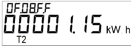
Рисунок 2.6 – Меню 1 Кадр 1. Энергия активная нарастающим итогом всего, в кВт·ч
