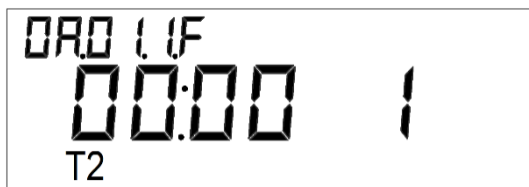
Рисунок 2.16 – Меню 7 кадр 10. Начальный кадр подгруппы. Время начала тарифной зоны 1 с указанием номера тарифа
